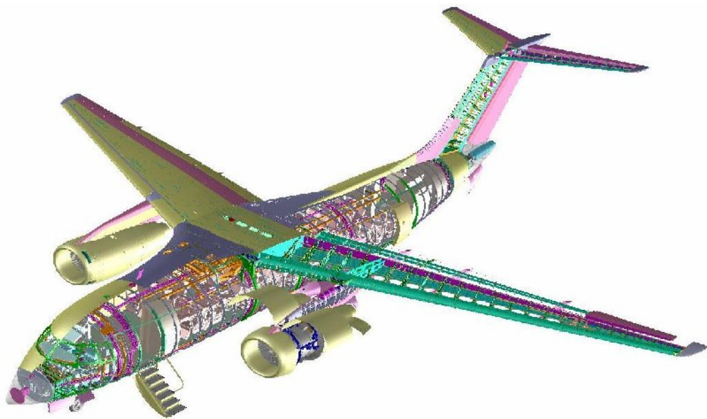
Рис. 5. Віртуальний макет літака з компонуальною ув'язкою компонентів конструкції планера, силової установки, систем і обладнання
