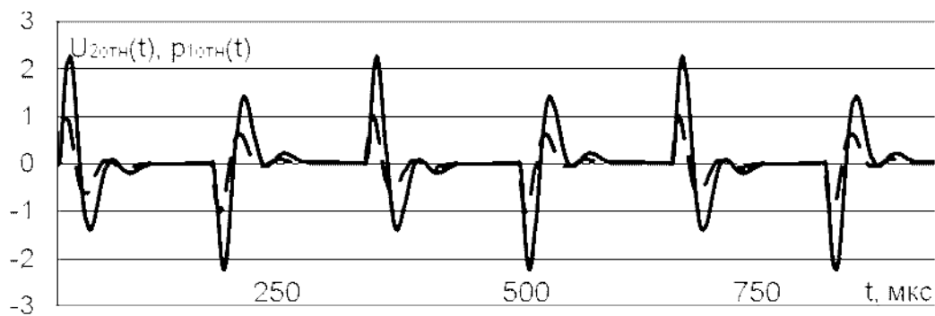
Рис. 6. Осциллограммы нормированного акустического давления на излучателе (пунктирная кривая) и нормированного электрического
