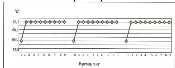
Рис. 6. Выходные сигналы НА А1 (а, б), А2 (в, г) и А3 (д, е) и их термодатчиков ТД А3 (ж) и ТД А2 (з), используемые для оценки: невоспроизводимости СН от запуска к запуску \overset{\circ}{k}_{0B} (а, в, д, ж); дрейфа СН \overset{\circ}{k}_{0Д}(t) и низкочастотных флуктуаций СН \overset{\circ}{k}_{0Ф} в запуске (б, г, е, з)
