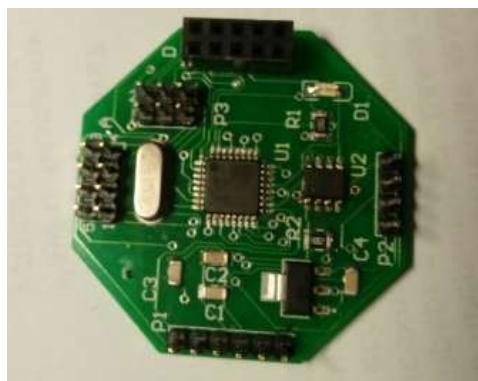
Рис. 2. Мікроконтролерний міні-модуль збору даних і керування: апаратна частина.
