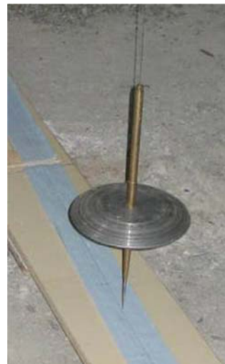
Fig. 10 - Foucault pendulum bob
