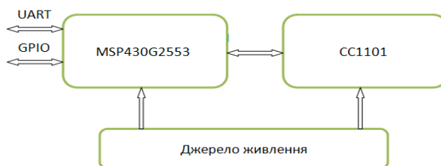
Рис. 1. Структурна схема вузла бездротової сенсорної мережі
