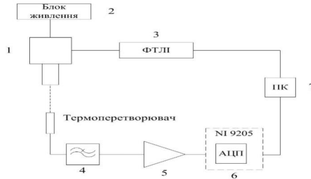
Рис. 1. Схема експериментального стенду. 1 – генератор оптичного випромінювання; 2 – блок живлення; 3 – формувач тривалості лазерного імпульсу; 4 – фільтр нижніх частот; 5 – підсилювач; 6 – модуль збору даних NI-9205 [10]; 7 – ПК
